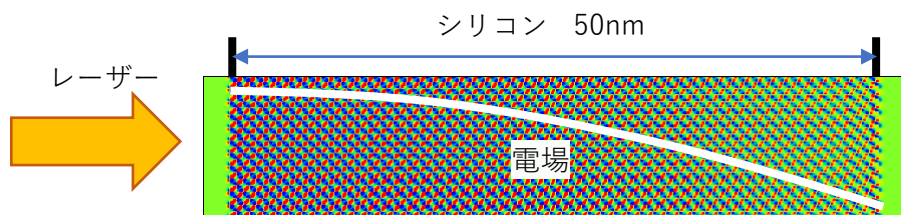
図2: シリコン薄膜にレーザーを照射している時の電子の運動の様子。赤は電子密度の増加、青は減少を表している。
