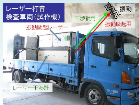
図:レーザーによるトンネル点検車両(試作機)
