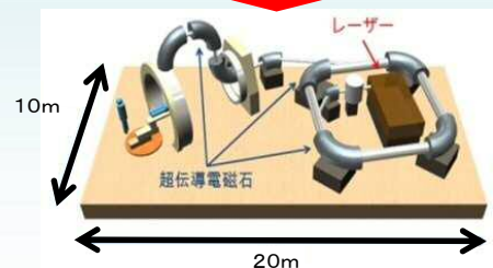
現在、最先端の普及型重粒子線がん治療装置
