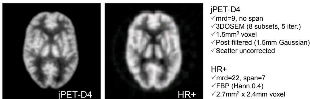
図 7 脳ファントムを用いた jPET-D4 と商用機 ECAT EXACT HR+ との比較。
