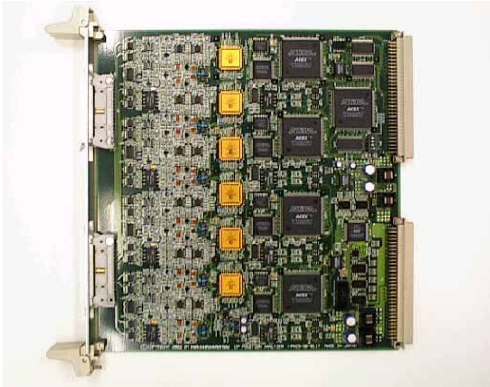
Fig. 2 Position Analyzer 回路基板 (但し DOI 検出機能は未対応)
