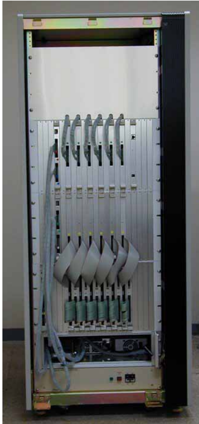
図3 . 同時計数回路部外観 (前扉を外した状態)
