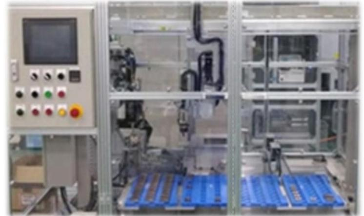
超音波探傷試験: UT (内部欠陥の自動検査)
