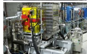
高エネルギー加速器研究機構 /高効率クライストロン用MgB 2 超伝導ソレノイド
