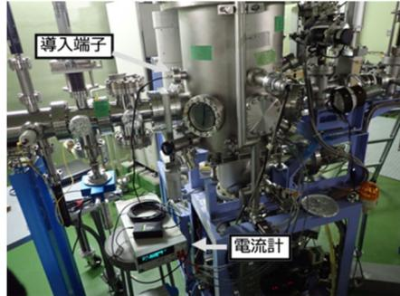
図2 TA1 チャンバーでの電流測定環境
