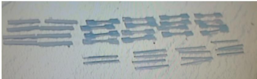
照射後の試験片。硬さを測ると計画通りの照射が行われたかどうかがわかる。問題がなければ試験を行う。試験の種類によって試験片の形状が異なる。
