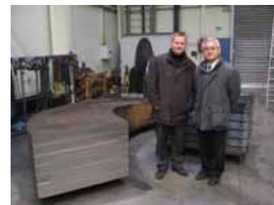
TFコイルケース用側板のプロ トタイプ (日本)
