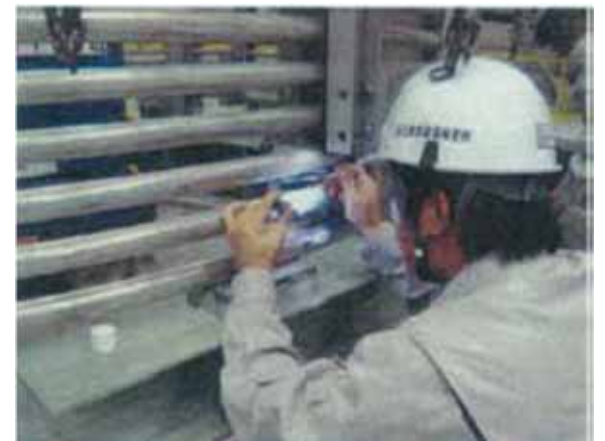
導体のヘリウムリーク試験と 浸透探傷試験
