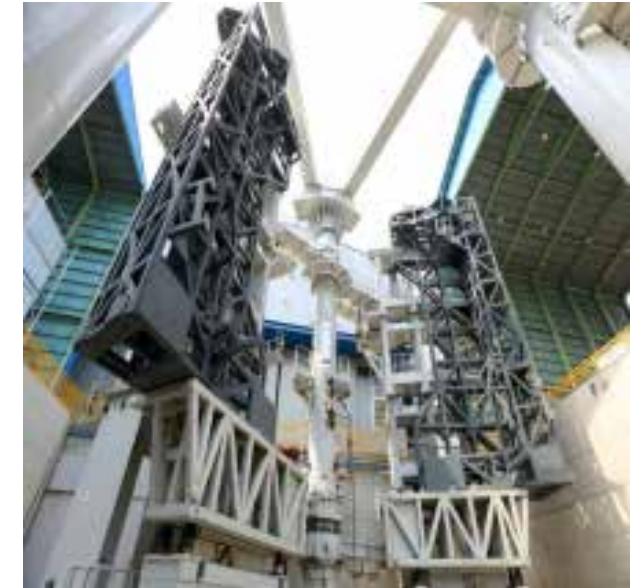
SSAT(正面) セクタ組立ツール 2機共に性能確認済
