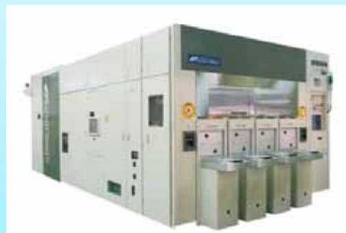
半導体製造用イオン注入装置 (提供：日新電機)
