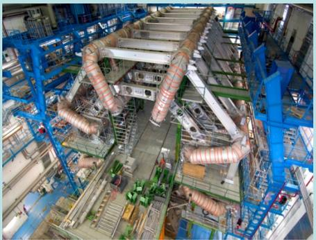
建設中の全長40mを超える大型観測装置ATLAS
