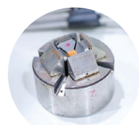
炭化タングステン製のパーツ で試料を6方向から加圧
