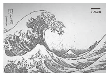
マイクロビームを撃ち分けて、 0.8mm×1.2mmの板に浮世絵を再現
