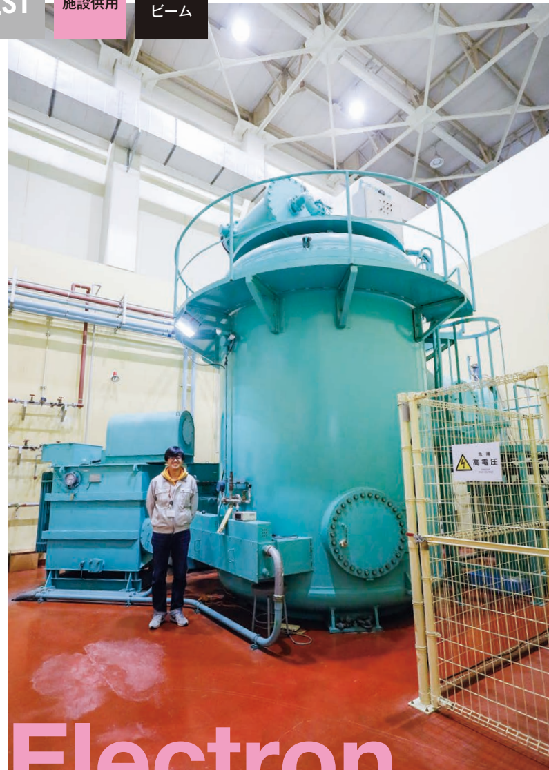
身長約175cmのスタッフと加速器との比較。水平方向（右奥）にも加速管があるのが特徴
