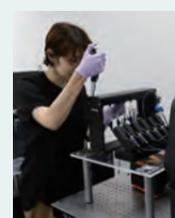
光ピンセットは、光のモーメントによって微粒子を操作し、タンパク質や核酸などを1分子で計測できます。分子の構造変化・運動や分子間の相互作用の強さをピコニュートンレベルで計測し、分子の働く様子を詳細に明らかにしていきます。
