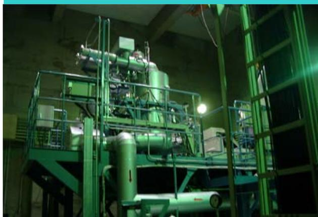
15m/s までの液体リチウム安定自由表面流の形成の確認 (阪大)
