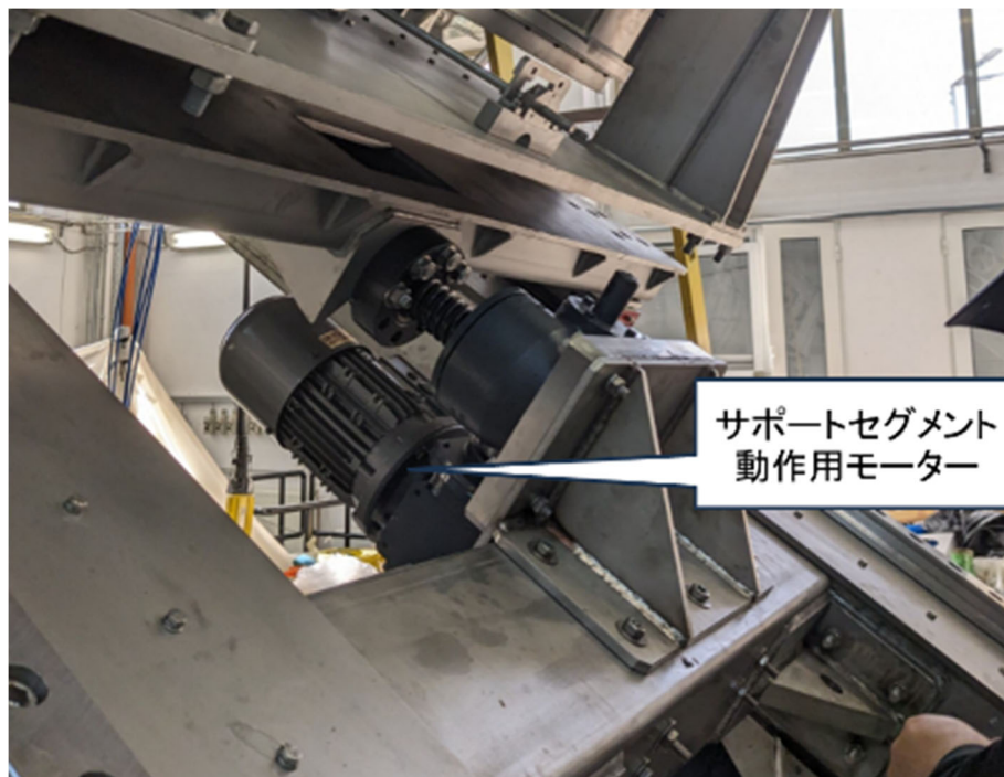
図 2.1.2-6 実際のサポートセグメント動作用モーター
