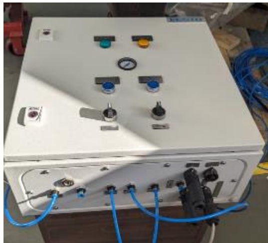
図 2.7.2 圧空制御ボックス（赤丸は固定金具取付位置）
