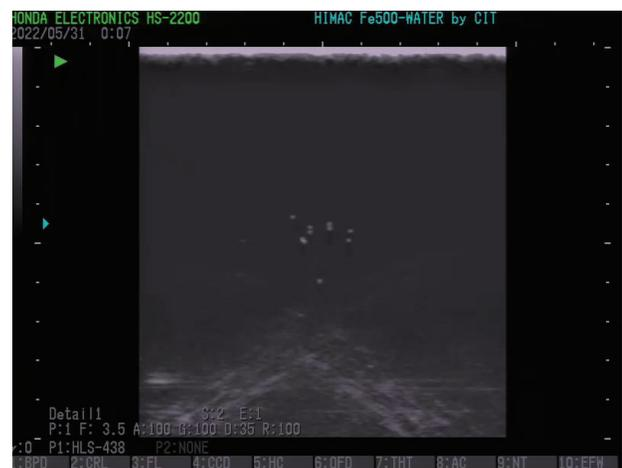
図1. HIMACで照射したFeビームの超音波エコー画像(1フレームを切り出した)の例。表2の条件と同じ。輝点は9個見えている。
