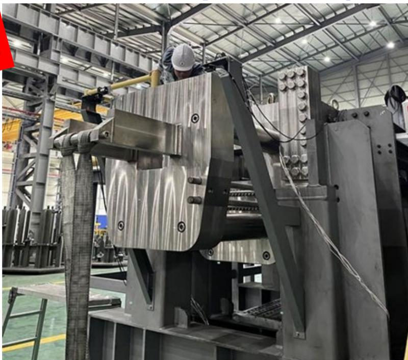
日本のアイデアを盛り込んだ下部ポート計測ラックの試作試験
