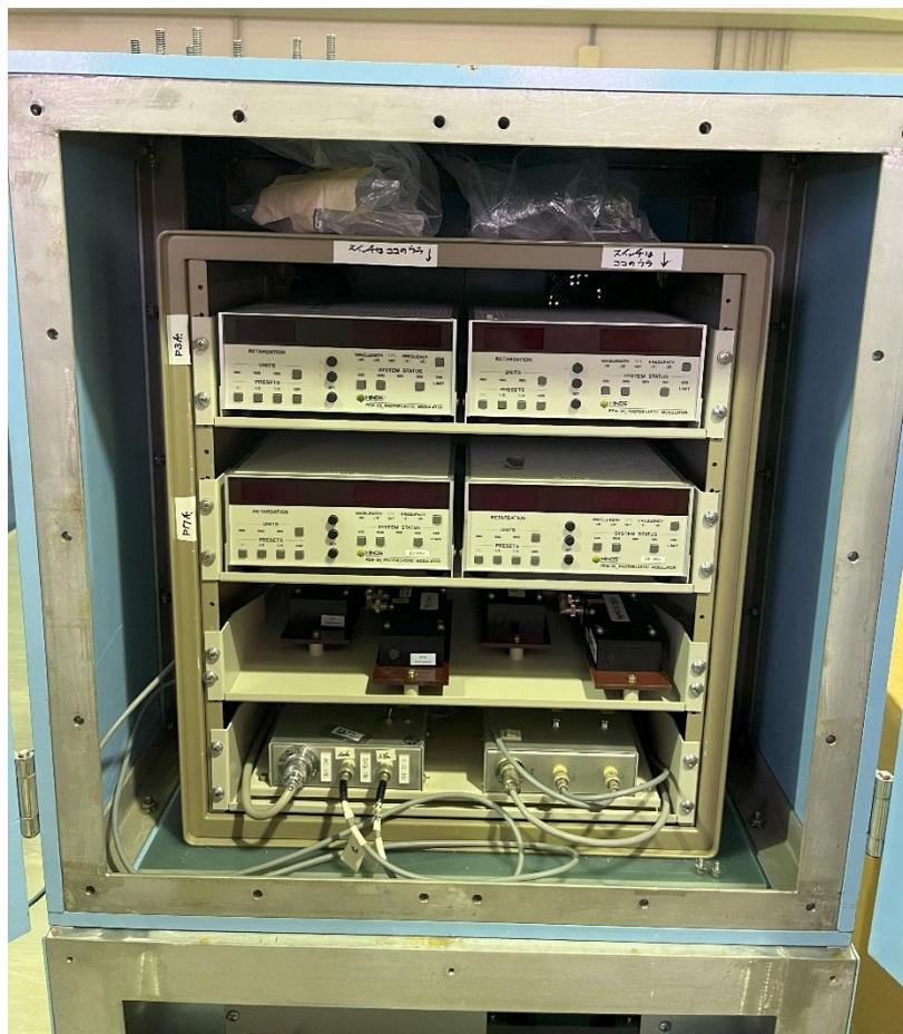
図1 MSE 計測器シールドボックス
