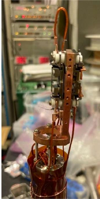
試作したXEOL測定装置
