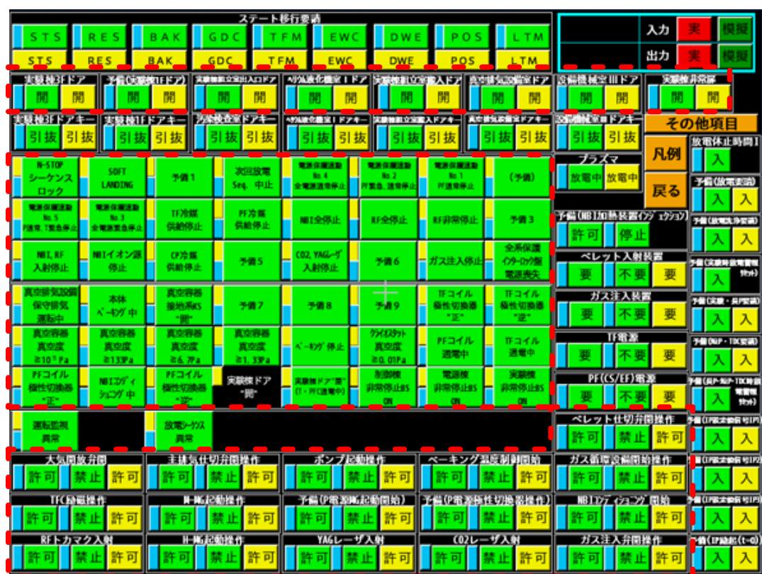
図 6 統括制御運転班卓上タッチパネル (対象範囲：図中赤点線枠内)
