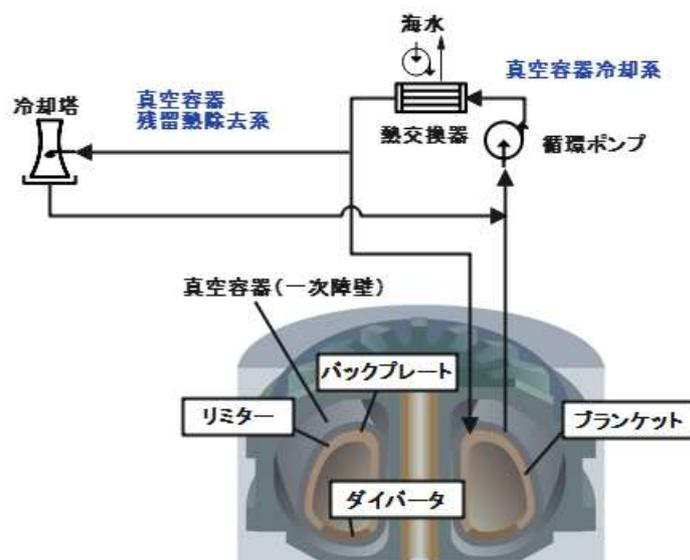
図1 真空容器残留熱除去系イメージ
