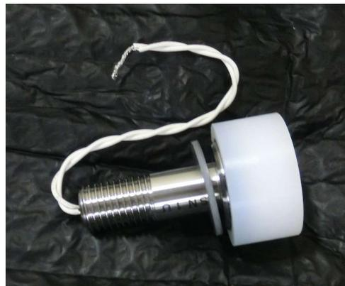
図 2 爆薬カートリッジ（上部用）の写真（参考用）
