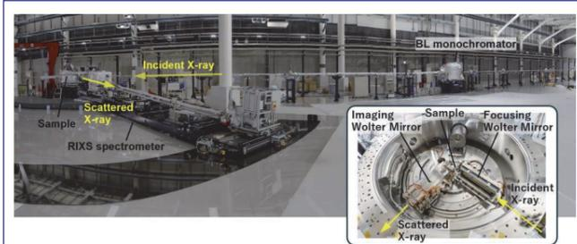
図) NanoTerasu BL02U と2D-RIXS 分光器の概観
