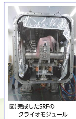
図) 完成したSRFのクライオモジュール
