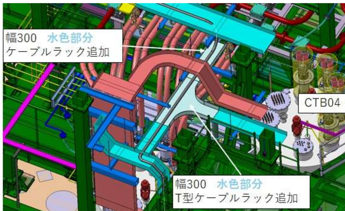
図 13 共通架台（P-05）1F に増設するトレイの配置図
