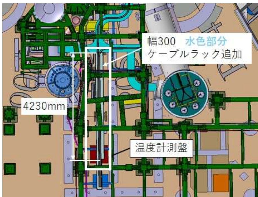
図 14 共通架台（P-05）3F に増設するトレイの配置図
