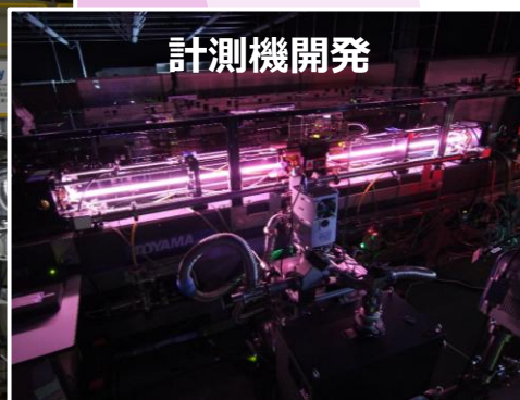
ダイバータ 高温ヘリウムリーク試験装置
