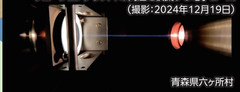
フュージョンプラズマの高温を模擬する電子ビーム (撮影:2024年12月19日)
