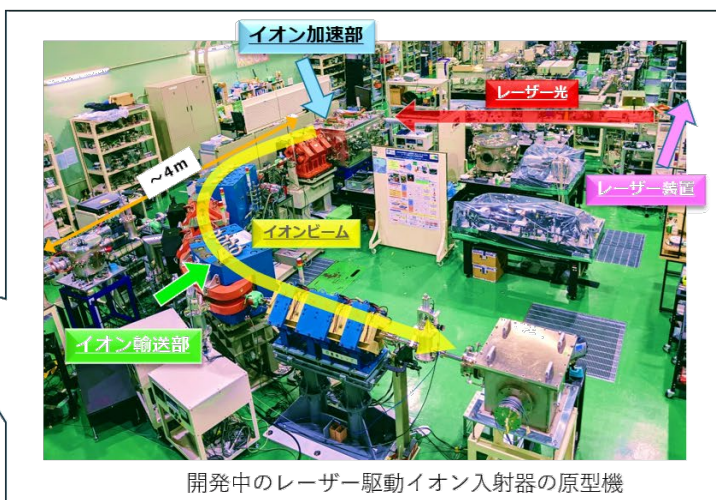
図1：量子メスの概要図（左）と開発中のレーザー駆動イオン入射器の原型機（右）
