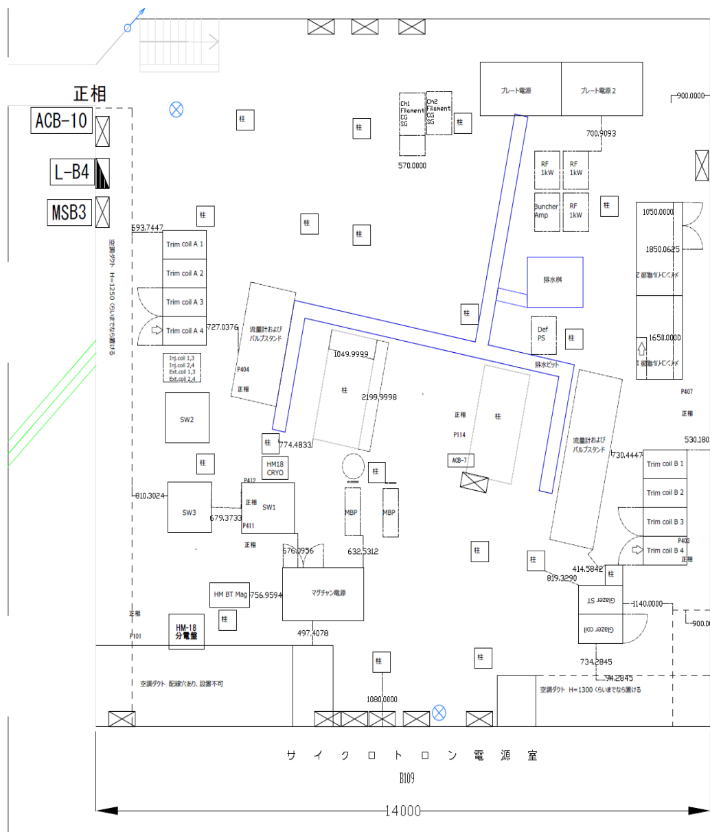
サイクロトロン電源室レイアウト図
