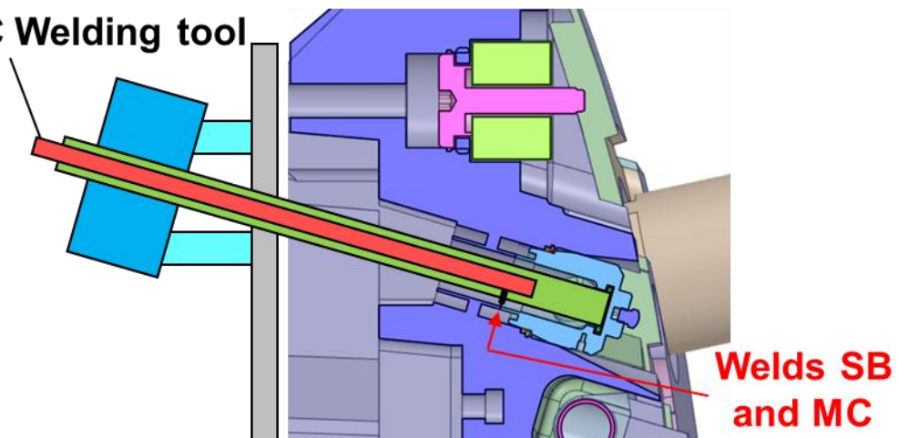
図 21 手順 6 : MCAMT を MCPT から引き抜き、MCWT を MCPT に挿入し、溶接を実施する
