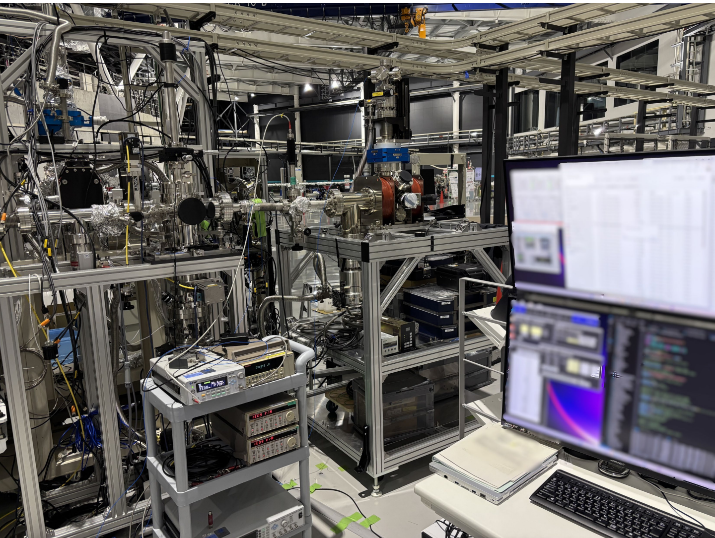
NanoTerasu BL13UIに設置したX線強磁性共鳴分光装置
