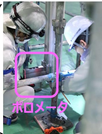
ボロメータでプラズマ放射パワーの空間分布を計測し、プラズマ制御に
