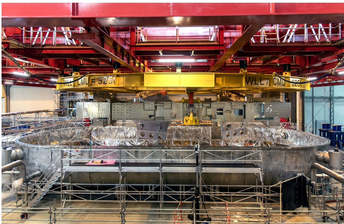
試験用のクライオスタット容器にトロイダルコイルが装着された様子
