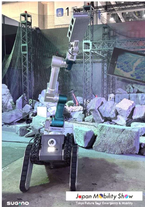
クローラ式小型作業ロボット
