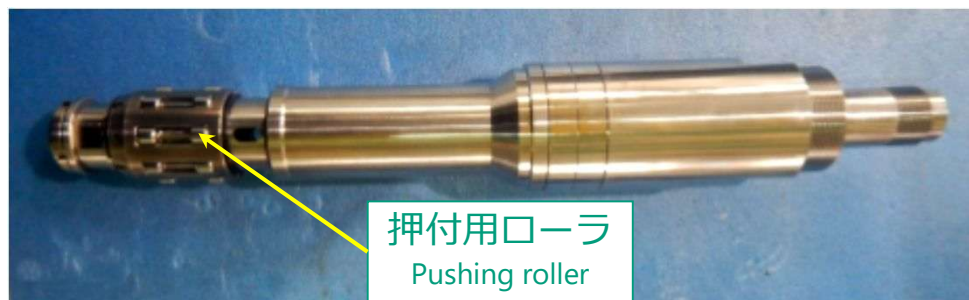
ローラによる開先合わせ (Roller type)
