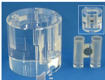
ORINSファントム Ref. ORINS-19 Thyroid radiiodine uptake measurement (1959).
