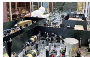
極短パルスレーザー装置
