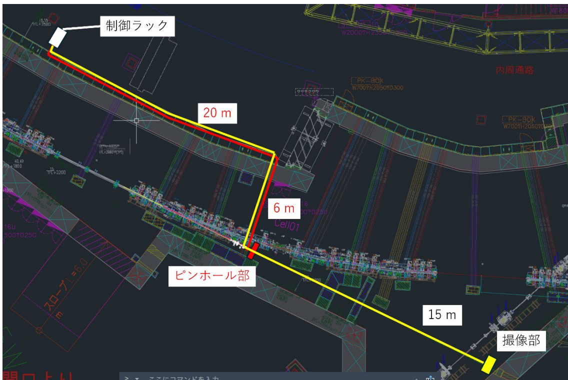
参考図 11 配線経路および設置場所 (長さは参考)
