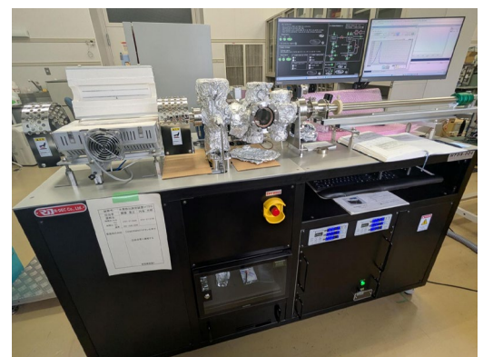
図2. 試料に蓄えられた水素量を測定する昇温脱離分析装置（TDS）
