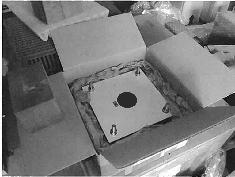
図 2 保管中の新規 DCCT
