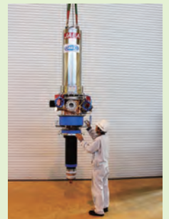
高周波加熱装置 ジャイロトロンと呼ばれる大電力ミリ波の発振管
