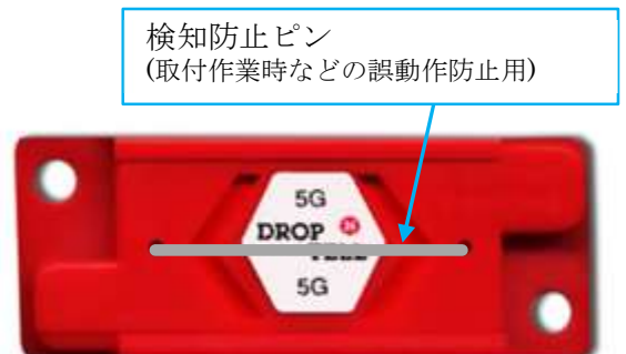
写真12 ショックインジケーター 名称：ドロップンテル 反応衝撃度：5G
