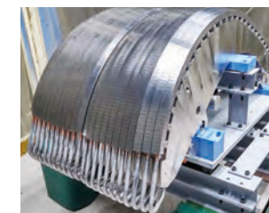
ITERダイバータターゲット
