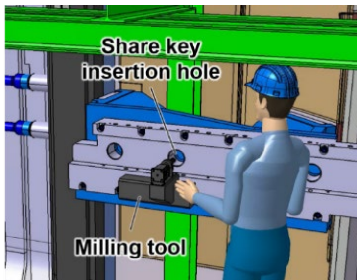
図 38 C 型サポートへのシェアキー穴加工の概念図
