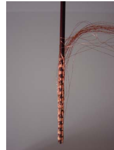
磁気プローブアレイの写真(上) とコイル1セットの図(下)
