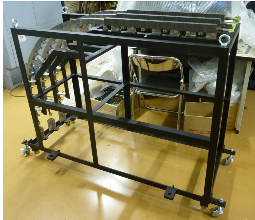
赤外サーモグラフィ検査用架台に組み込まれたPFU#1 (3体のPFUを同時に検査可能)
