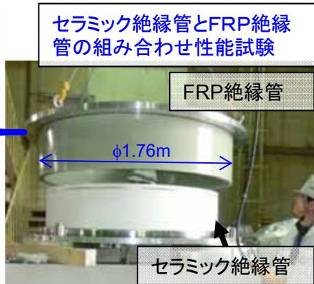
セラミック絶縁管とFRP絶縁管の組み合わせ性能試験
