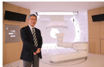
回転ガントリー（重粒子線がん治療装置 HIMAC の一部で、360度の任意の角度からの照射を可能にする装置）を導入した治療室にて
