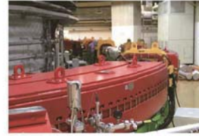
放射線医学総合研究所にある重粒子線がん治療装置HIMACのシンクロトロン
