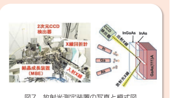
図7 放射光測定装置の写真と模式図
